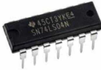
চিত্র ১.১৫: নট গেট আইসি (হেক্স ইনভারটার) এর বাস্তব অবয়ব
