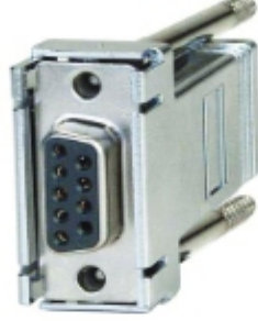
চিত্র : COM পোর্ট
