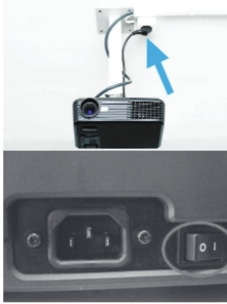
চিত্র: পাওয়ার কানেকশন পোর্ট
